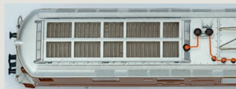
Die Dachansicht der schweizer Konstruktion mit der bereits 1969 vorhandenen feinen Abdeckung aus Gittergewebe des Widerstandaufbaus
