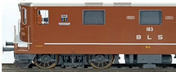
Der zu lange Radstand und der vorbildgerechtere Abstand an den Achslagerblenden stimmen beim Lima-Modell nicht überein. Alle Maschinenraumfenster sind ohne Andeutung von Aggregaten
