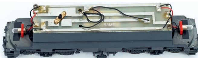
Das Chassis der Lima-Ellok mit Glühlämpchen und einfacher Platine ohne Digitalschnittstelle, wie es Anfang der 1990er Jahre durchaus noch üblich war
