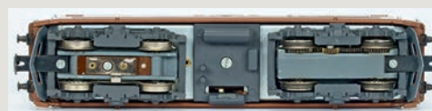
Das HAG-Fahrwerk der Zweileiter-Gleichstrom-Ausführung; der Antrieb erfolgt nur über ein Drehgestell, dafür jedoch mit vier Haftreifen
