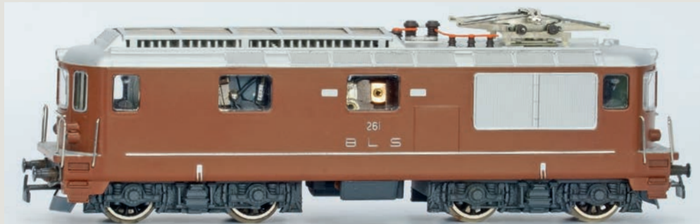
Die BLS Ae 4/4 261 von HAG als Version im Ablieferungszustand, nachträglich verfeinert mit Rifelfleblechfolie und einem Stromabnehmer aus der einstigen Zubehörfertigung von Am Ryhn
