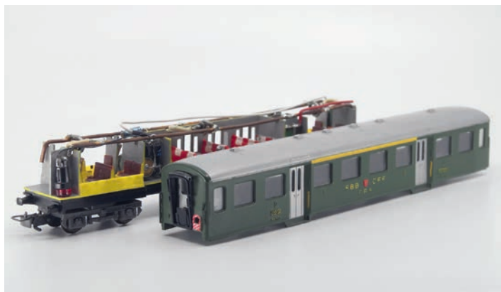
Kleinbahn regte zum Umbauen an: bemalte Einrichtung, Blinkelektronik für die Schlussbeleuchtung und Innenbeleuchtung, Stand 1960er Jahre (umgebaut von Ruedi Wiedmer T).
