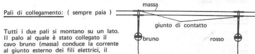
Tutti i due pali si montano su un lato. Il palo al quale è stato collegato il cavo bruno (massa) conduce la corrente al giunto esterno dei fili elettrici, il palo portante il cavo rosso conduce la corrente al giunto interno.
